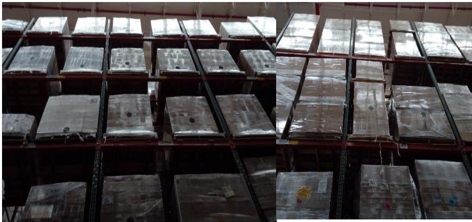
Ilustración 20 Tarimas con material en altura correcta según requerimiento de FM Global
